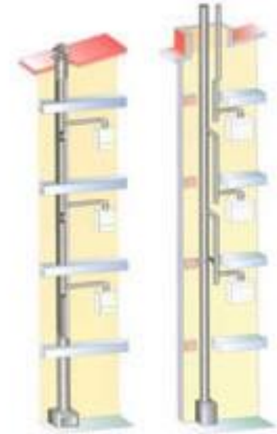
Esempio di installazione Canna fumaria ramificata collettiva con condotto secondario interno ed esterno
